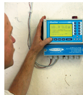
Heatime er en komplet enhed der er enkel i brug og yderst robust. Displayet er altid tændt, og en rød lampe lyser tydeligt, når et dyr er i brunst.
